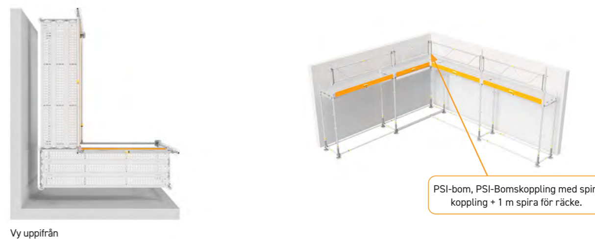
Invändigt hörn 0,75 bredd, 2 st spiror i hörnet
