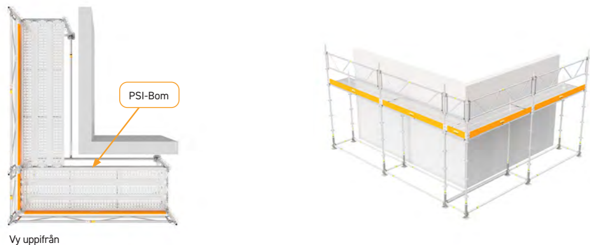
Utvändigt hörn 0,75 bredd med 0,25 konsol, 2 st spiror i hörnet
